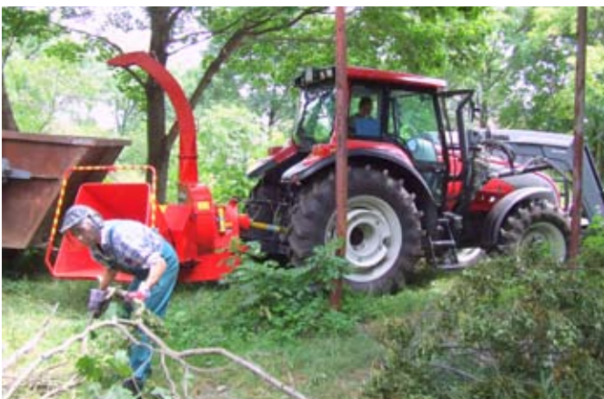
Štiepkovanie konárov z obecnej zelene štiepkovačom Junkkari
